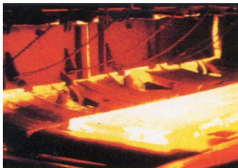
Il problema sollevato dal cliente (ILVA) riguardava l'estrema difficoltà nel rilevare la posizione della bramma durante la fuoriuscita dal forno per evitare sia la sovrapposizione della bramma successiva che un errato inserimento sulla via rulli trasversale.
