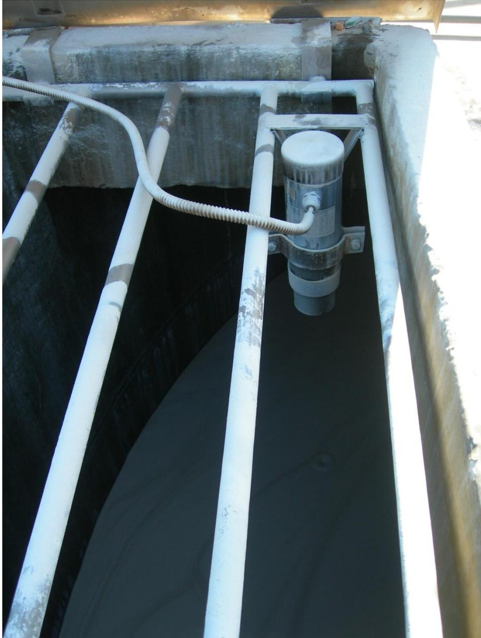
misura livello caolino liquido caldo in serbatoio 10mt
